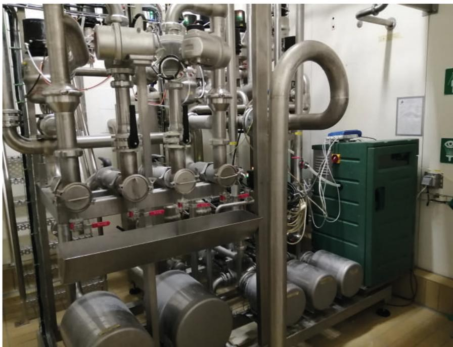
Photo 2. : Vue d'une partie du nouveau système de nettoyage (NEP) principal de la HTLA
