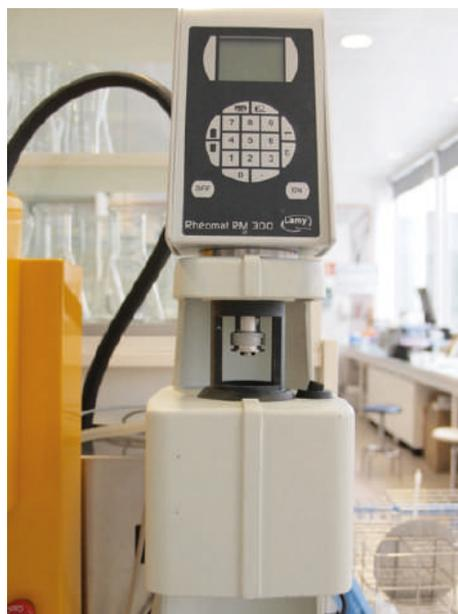
Photo n°3 : texturomètre RHEOMAT 300
