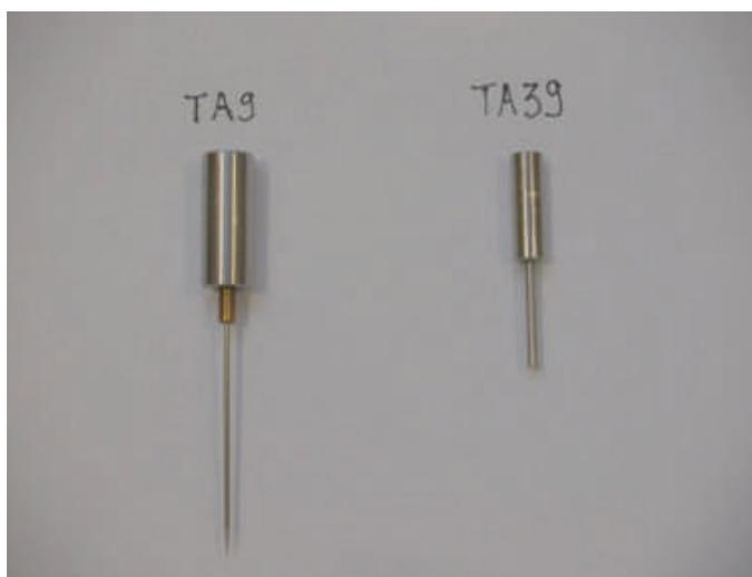
Photo n°2 : Mobiles TA9 et TA39 pour pénétromètre Brookfield CT3
