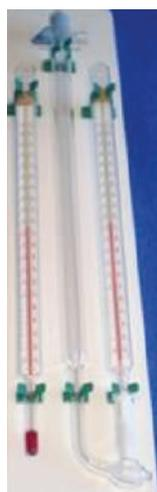
Photo N°3 : Psychromètre avec thermomètre à alcool humide et sec.
