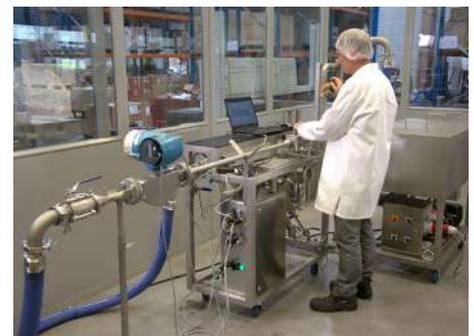
Figure 8 : banc d'étalonnage mobile autonome Endress+Hauser
